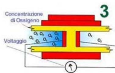
**3:** Se c'è differenza di concentrazione di ossigeno tra i due lati del disco, viene generato un voltaggio rilevato dagli elettrodi.
